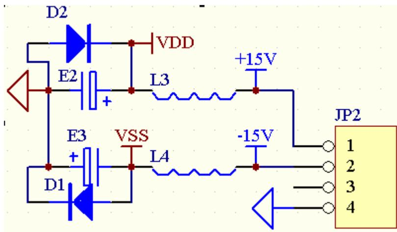
图 7 模拟电源的接线原理
