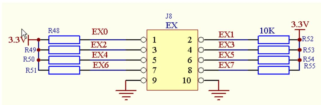
图 8 外触发启动信号
