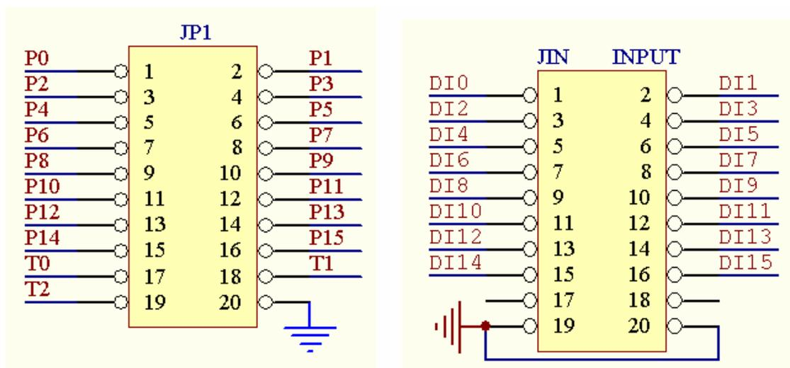
图 3 开关量输入的原理与接线图
