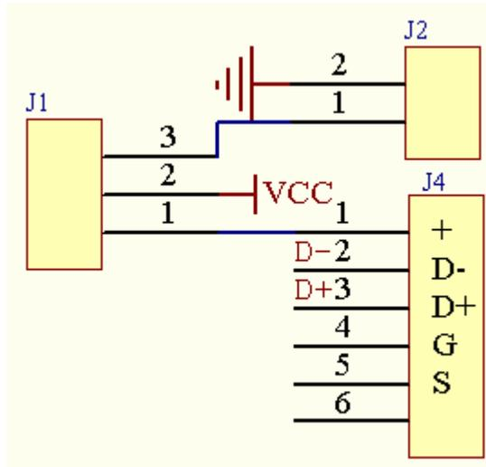
图 6 数字电源的接线原理
