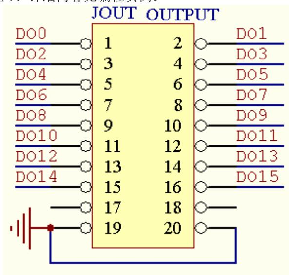
图 4 开关量输出的原理与接线图
