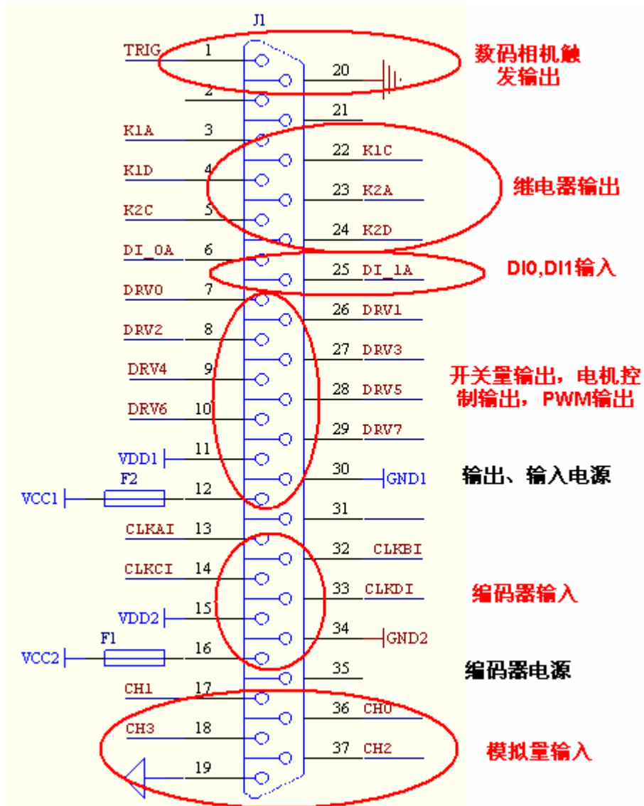
图 8 开关量输出与编码器输入接线
